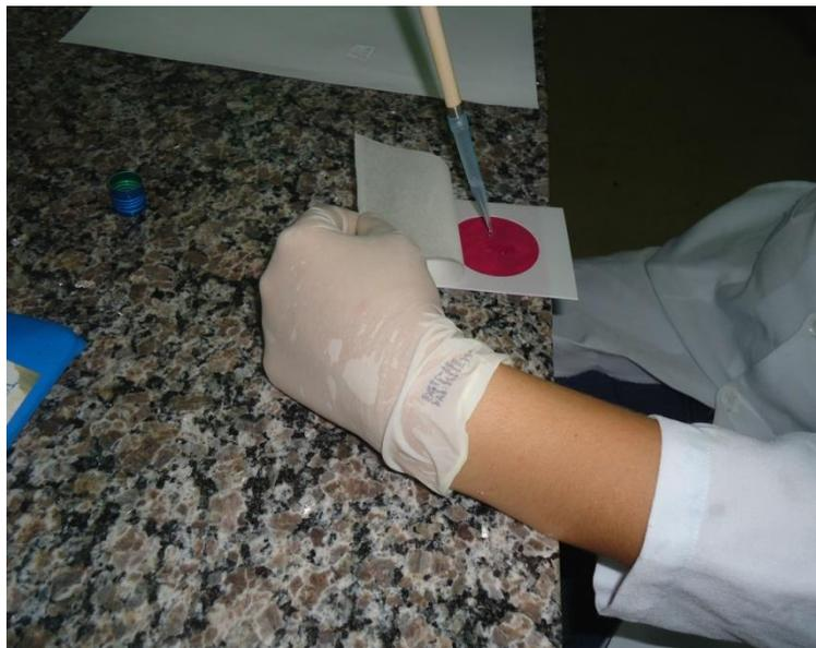
**FIGURA 4-** Após agitação, pipetou-se um ml da solução e inoculou-se em placa Petrifilm™ para contagem de Coliformes totais, *Escherichia coli*, Bolores e leveduras. Um ml de cada solução também foi inoculado em placa pelo método *pour plate* em Agar *Baird Parker* para contagem de *Staphylococcus aureus*.
