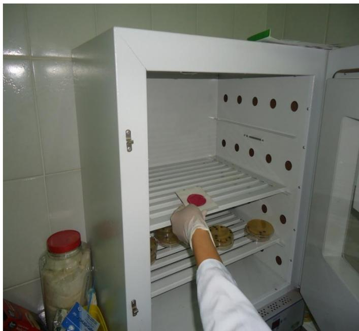
**FIGURA 5-** Após o processamento das amostras, as placas foram incubadas em estufa a 35°C por 24 horas e submetidas à contagem.
