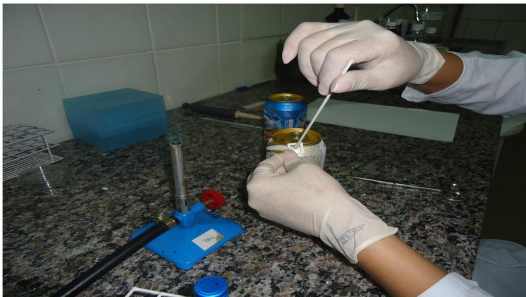
**FIGURA 01-** Área utilizada para análise e coleta dos microrganismos no local que entra em contato com a boca do consumidor e para isso foi utilizado um molde vazado com área de 1 cm<sup>2</sup>.As amostras foram obtidas com o auxílio de um swab embebido em água peptonada 0,1% pelo método de esfregaço.
