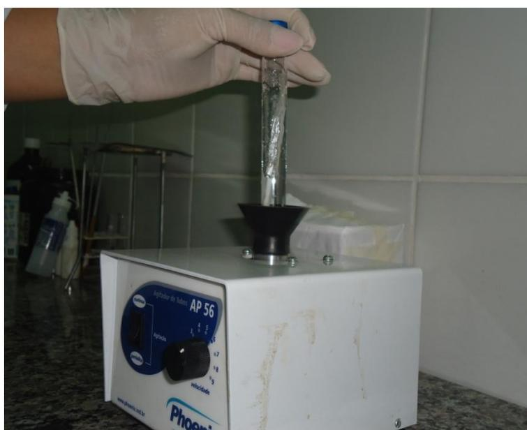
**FIGURA 3-** Os tubos foram devidamente fechados e a solução foi homogeneizada em um agitador de tubos.
